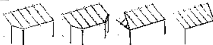
Beispiele Sonderflächen, die mit seitlichem Überstand beschattet werden können.
